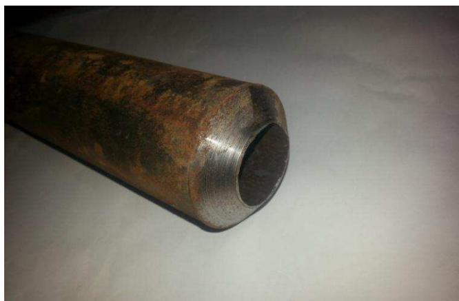
Fig. 12 Préparation des chanfreins selon les paramètres utilisés
