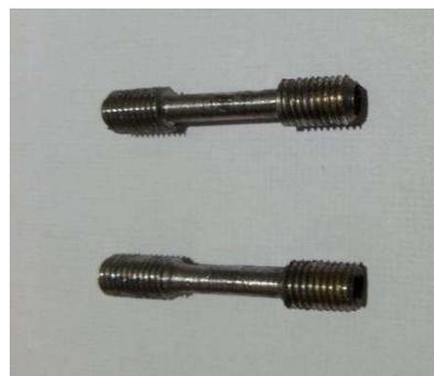
Fig. 21 Filetage et finition des éprouvettes
