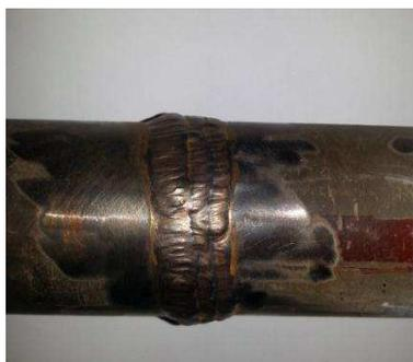
Fig. 14 Joint de soudure de l'acier T91
