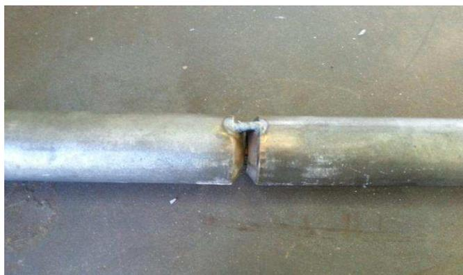
Fig. 13 Soudure qualifiée des joints
