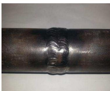
Fig. 15 Joint de soudure de l'acier T22
